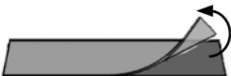
5. Legen Sie nun das Wärmeleitpad mit der Seite ohne Folie direkt auf die M.2 NVMe SSD auf und entfernen Sie die zweite durchsichtige Schutzfolie.
